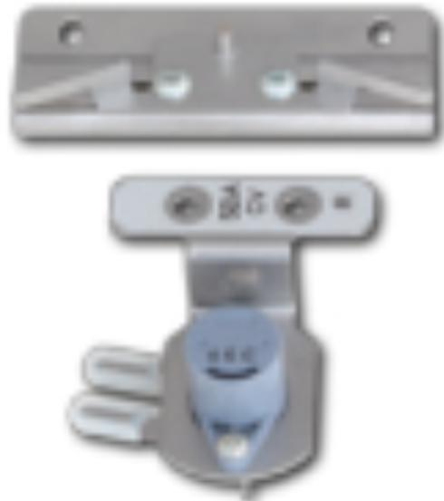
关门器的使用要求：1. 使用环境——消防防火要求和在冬季零下35° 下的场所的防冻要求。2. 阻尼缓冲功能——快速开门到一定位置后产生阻尼缓冲，而且该阻尼缓冲力量与范围可以根据使用要求自行调节；该功能用于防止用力快速开门时门或锁碰撞墙面，或应急逃生时防止人在快速开门时失重而向前倾斜倒地。3. 延时慢速关门——门从开门的较大位置开始匀速缓慢关闭，可根据要求进行无级调节。适宜用在出入频繁且人多的场所，特别是医院，有老人、儿童与残疾人出入的门与通道使用。
